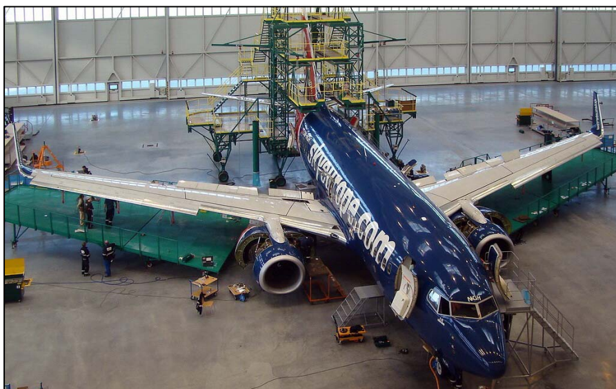
▲ Extrémní zatížení podlahy 3x30t je vyvozeno trojnožkami při výměně pneumatik podvozku.
